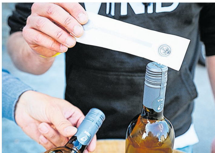
Das Siegel mit dem NFC-Tag muss von Hand an den Weinflaschen angebracht werden. Bild: Rudolf Hirtl
